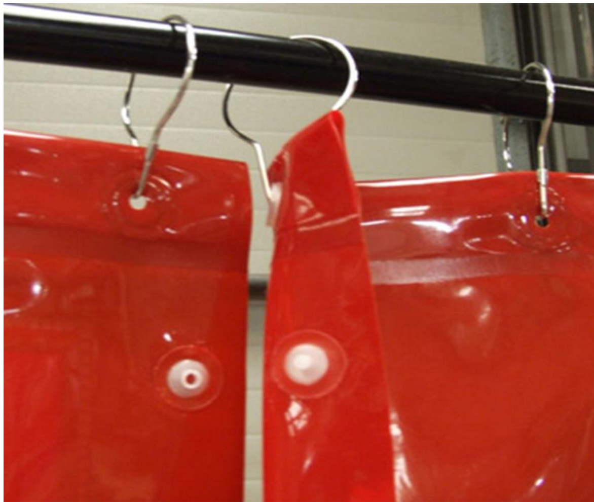
Рисунок 2.10 - Защитные сварочные ограждения рабочих зон
